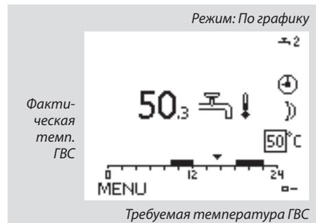
Кроме информации о требуемой и фактической температуре ГВС, на данном экране отображается текущий график.
